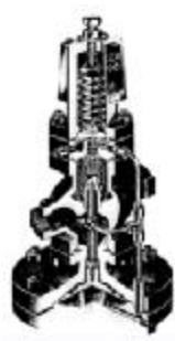
Válvula reductora de presión
