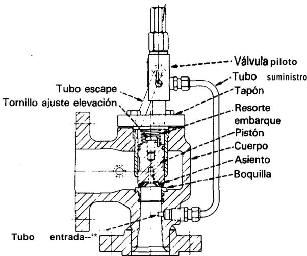
Fig. 6 Válvula de desahogo de seguridad con piloto
