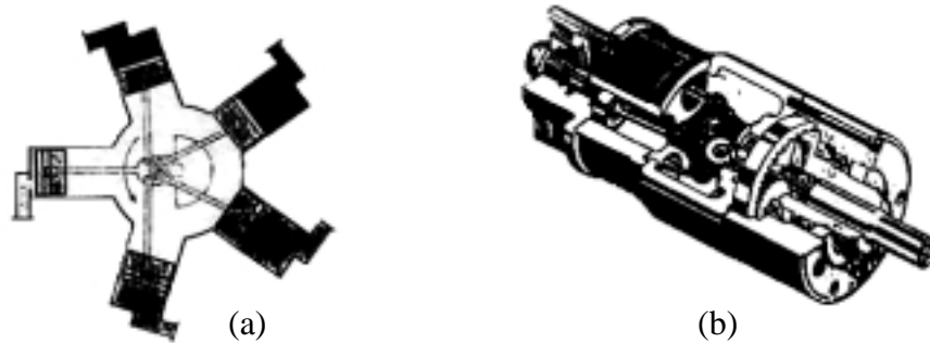
Figura II.86. Motor de émbolo: (a) radial; (b) axial
