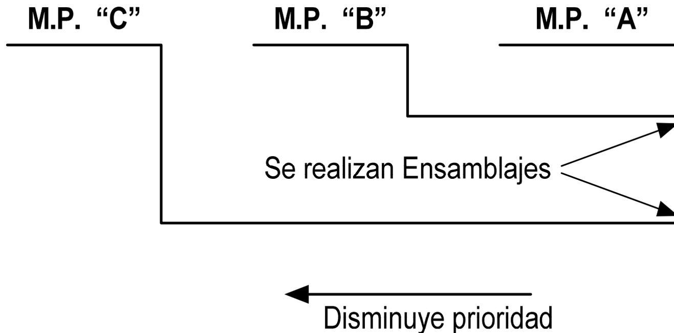
La unión de un componente con el principal se indica con una línea horizontal entrante a la línea vertical de flujo al lado izquierdo.
