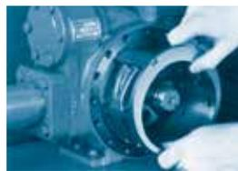
El revestimiento reemplazable restaura la eficiencia con facilidad.
