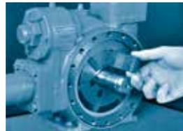
El reemplazo simple de las paletas no requiere herramientas especiales.
