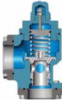
Sección transversal del modelo BV2
